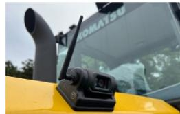
バッテリー内蔵型ワイヤレスカメラで最大300mまで離れた場所から監視できます。設置面はマグネットになっており車両や機械にワンタッチで取り付け、取り外しできます。また録画機能付きワイヤレスモニターもご用意しておりますので、面倒な配線工事等不要で即使用可能です。車両のバックカメラ、サイドカメラ、ショベル・クレーン類のアーム先端カメラ、フォークリフトのフロントカメラなど、様々な場面で使用できる便利なアイテムです。
