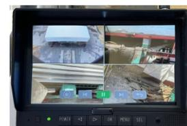
CA97W やCA14Wワイヤレスカメラと連携して、最大4カメラまで同時に監視できます。モバイルバッテリー（別売り）やシガーソケットから給電できますので、急遽フォークリフトや建設機械にカメラを取り付けたい、トラックにバックカメラを取り付けたい、となった場合にも対応可能です。また録画機能付きで128GBまでのSDメモリーカード対応しておりドライブレコーダーとしても活用できます。
