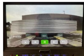
フォークリフトの先端にマグネットで取り付けし運転席から爪先の様子を監視できます。充電式バッテリーから給電できますので面倒な配線工事も必要ありません。耐震は ISO 16750-3、IP69K防塵防水仕様と、丈夫な金属ケースで設計されているのでフォークリフトカメラ以外に工事現場、解体現場などの厳しい環境でも活用できます。
